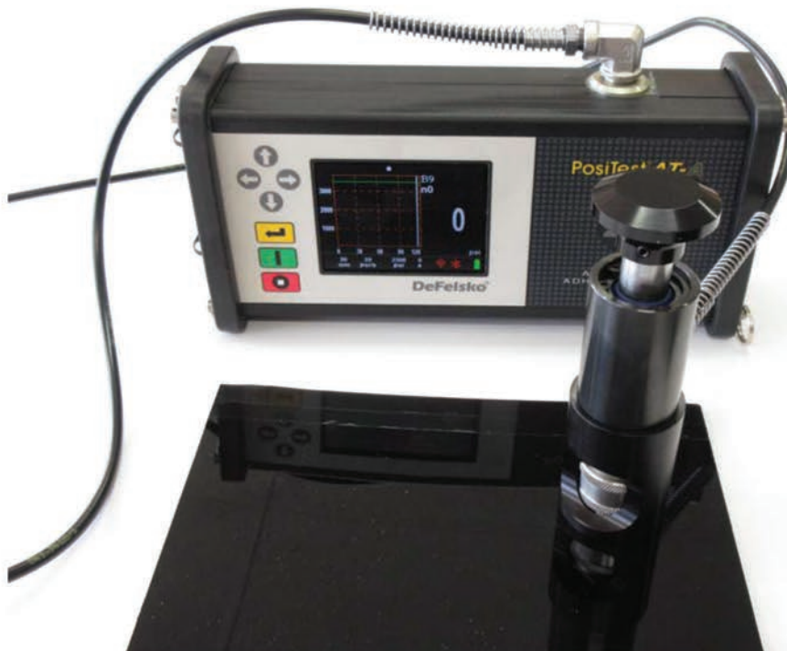
Setup typique pour les essais d'adhésion
